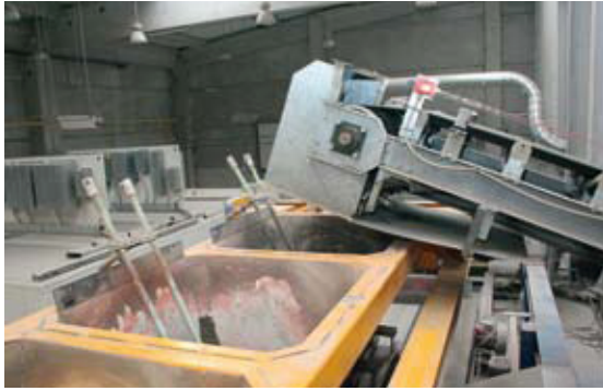
Abb. 2 An die Mischerebene angeschlossene Colormix-Einheit.
