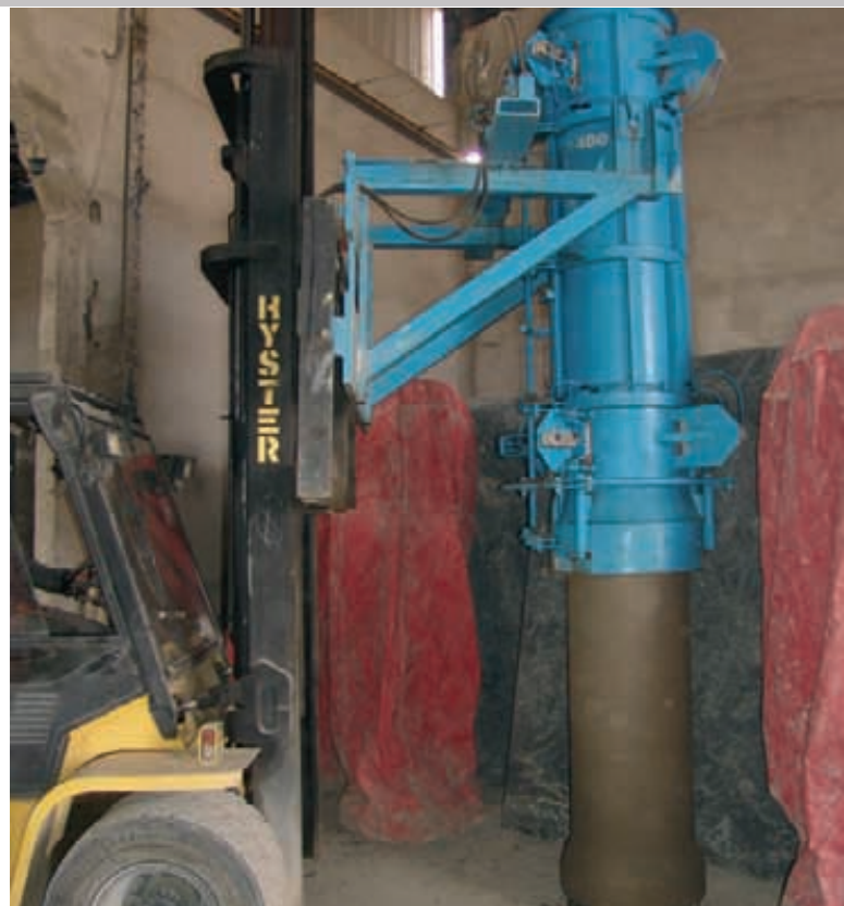
Rohrabräumen mit Gabelstapler
