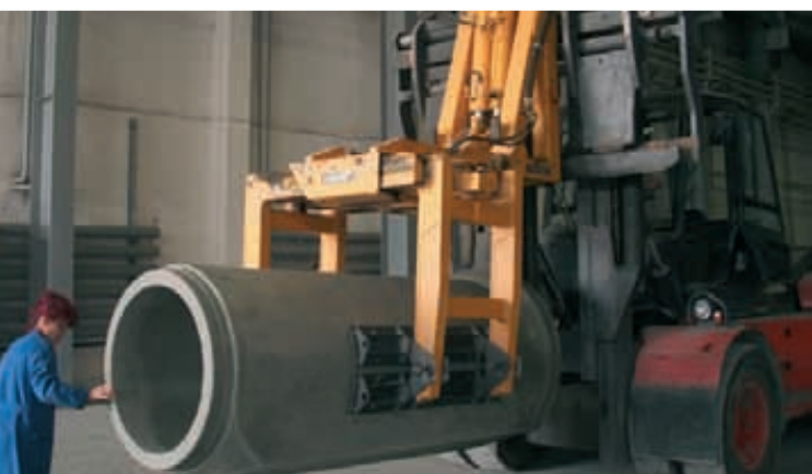
Entschalen mit Gabelstapler
