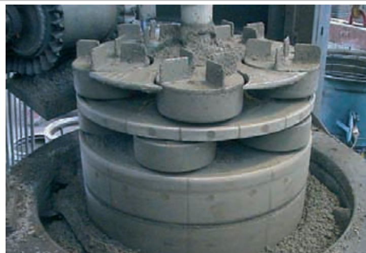
SP RADIALPRESSE RP 830, vollautomatisch mit Staplerbetrieb
