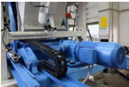
elektrisch geregelter Füllgitterantrieb
