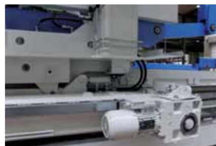
Unidad de elevación de mesa con ajustador automatico
