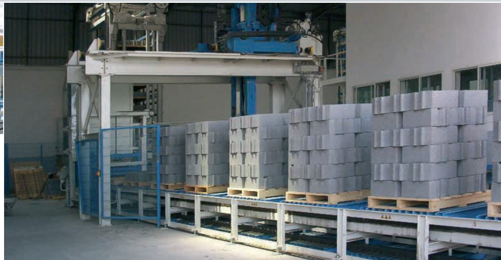
Palettierte Betonprodukte auf Stegband
