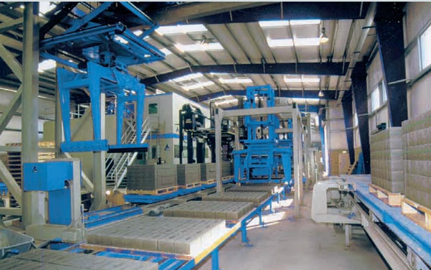
Trockenseite mit Elektroklammer, Pakettransport mit Übersetzer
