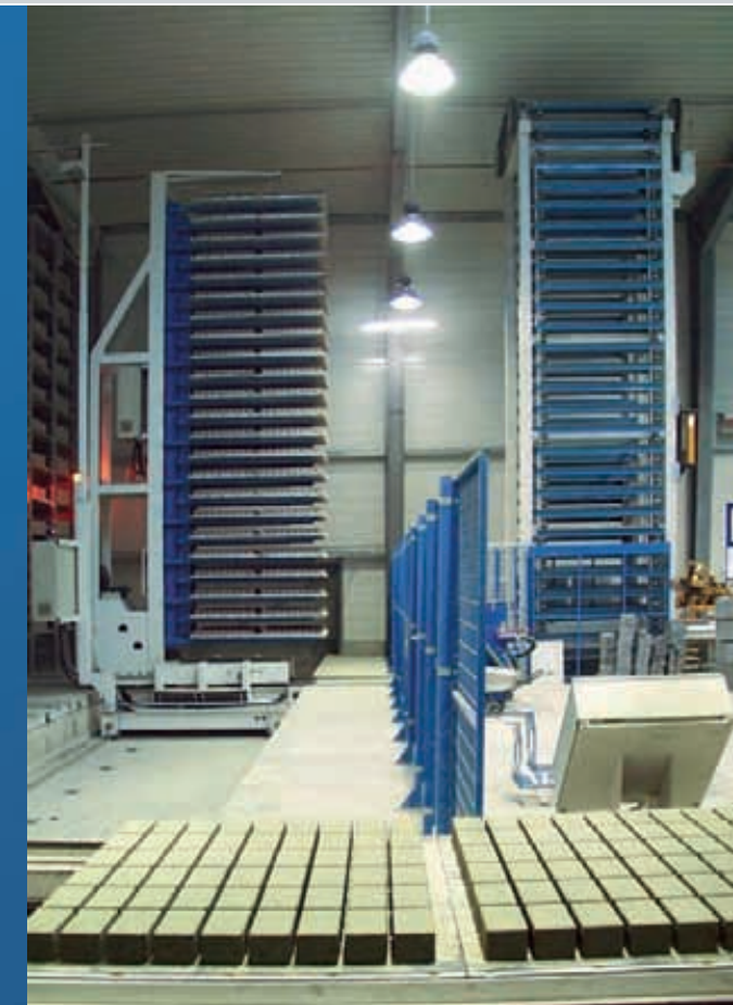
drehbare Fahrzeuggruppe mit 23 Etagen, 24t Traglast
