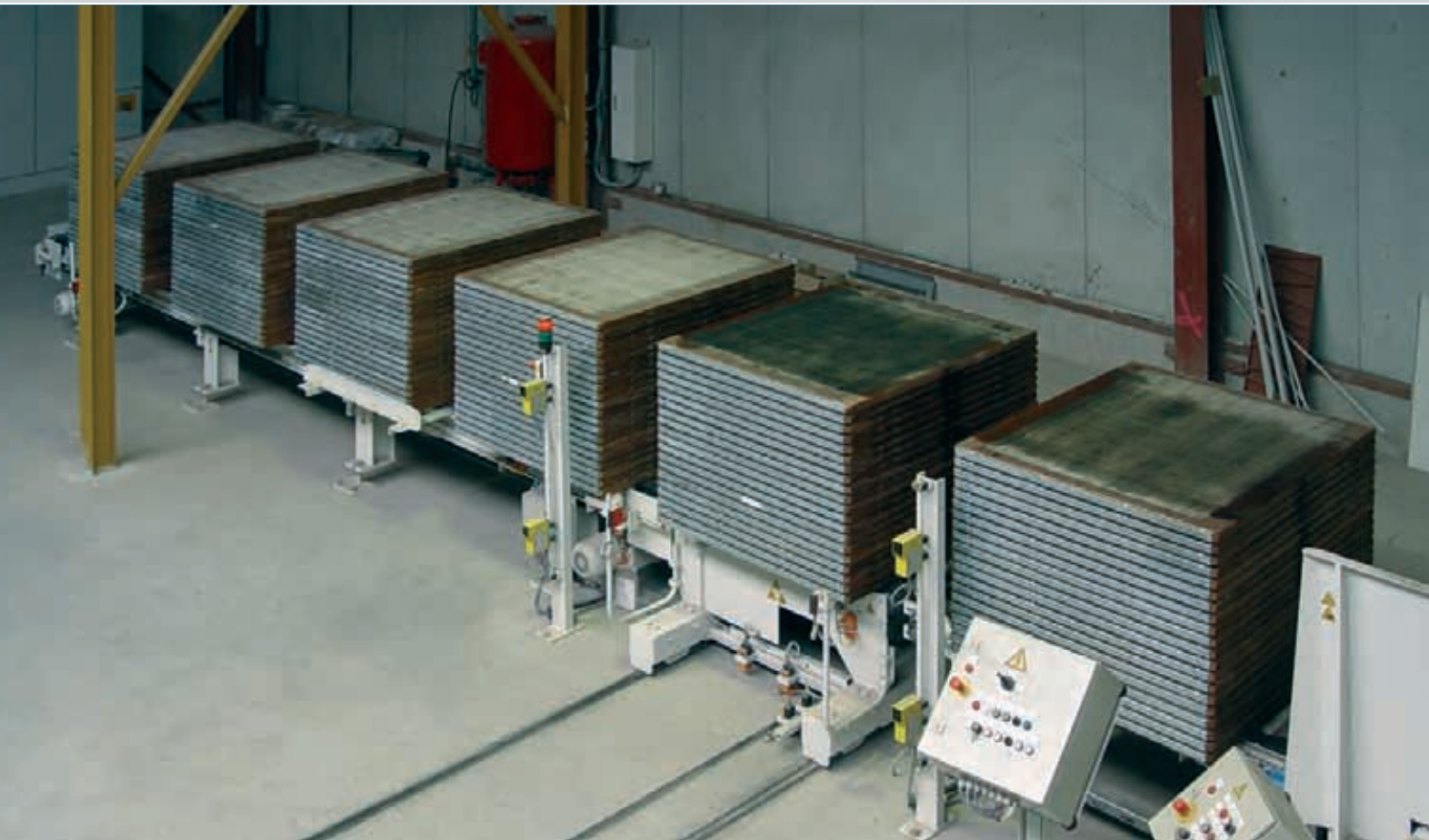
Brettstapeltransportwagen mit Pufferbahn
