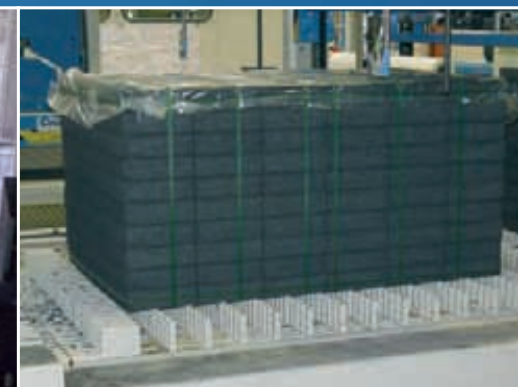
Freihubrostförderer mit wechselbaren Rosten für Vertikalumreifung
